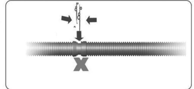
• An den Schlauchverbindungen dürfen keine Undichtheiten auftreten.
